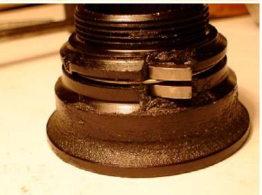
8. Распределяем смазку равномерно по всей дорожке в этом деле самый замечательный инструмент- палец
