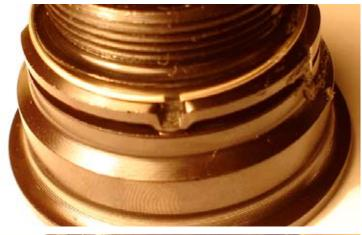
5. Одеваем пружинное кольцо ориентируем его разрез на выступ в канавке втулки
