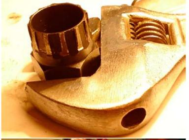
1. Съемник кассеты и подходящий к нему ключ если мы планируем разбирать трещетку не на колесе
