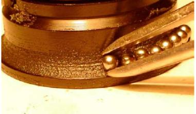
9. Наклеиваем шарики пинцетом - удобнее, пальцами - веселее и забавнее для окружающих ... и никакого суперклея, смазка и только смазка, хотя с суперклеем было бы удобнее на шаге 11
