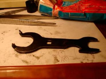
2. ключ для откручивания гайки трещетки раньше это было обычным ключом от велосипеда-раскладушки, но правильный подход к электроточилу/напильнику превращает его в нужный инструмент
