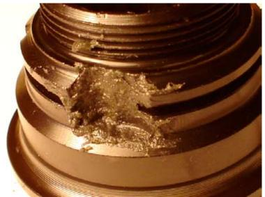
3. Отмытую и просушенную втулку трещетки начинаем нещадно пачкать свежей смазкой отмываем в бензине/уайт-спирите; сушим тряпкой; смазки укладываем достаточно (моё "достаточно" обычно трактуется слесарями - как "дофига намазал")
