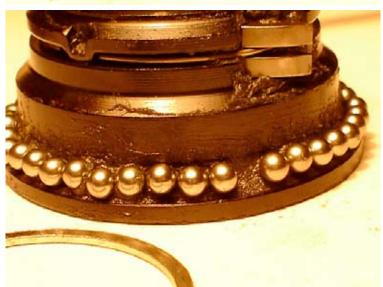
10. Вот что получается когда все шарики наклеены не паримся по поводу оставшегося промежутка между крайними шариками - для насыпного подшипника - это конструктивная фича; не фичей считается промежуток более чем в 2 диаметра шарика - значит при разборке шарики "разбежались", но ничего, мат, фонарик и магнит ... в общем, ищем шарики
