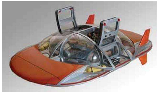
тельно, похожа на подводный самолет. Аппарат способен погружаться на 330 метров и развивать под водой скорость 11 км/ч. Такой подводный самолетик стоит 1,3 миллиона \$.
