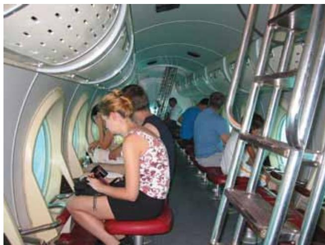
Туристические подлодки отличаются от военных весьма скромными размерами, небольшим временем погружения и наличием больших акриловых иллюминаторов толщиной 7,6 см. Погружаются такие лодки на 20-35 м, продолжительность подводной прогулки обычно не превышает одного часа. Внутри корпуса лодки, как правило, большой салон с сидениями, температура поддерживается кондиционерами на комфорtnом уровне, давление воздуха равно атмосферному давлению на поверхности.
