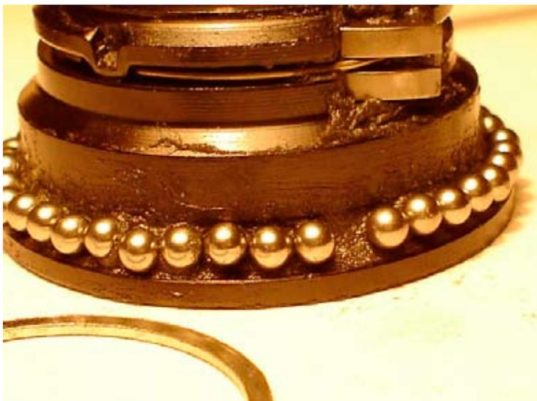
10. Вот что получается когда все шарики наклеены не паримся по поводу оставшегося промежутка между крайними шариками - для насыпного подшипника - это конструктивная фишка; не фичей считается промежуток более чем в 2 диаметра шарика - значит при разборке шарики "разбежались", но ничего, мат, фонарик и магнит ... в общем, ищем шарики
