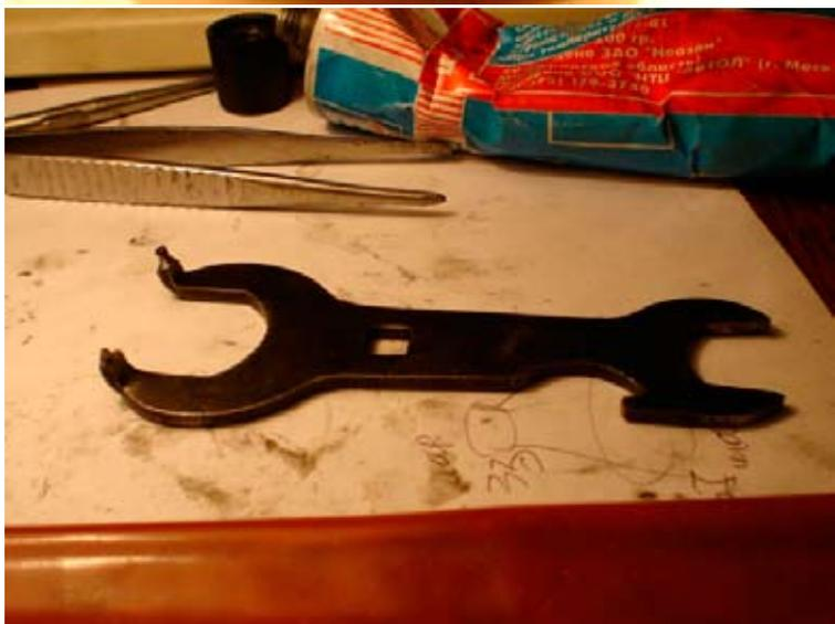
2. ключ для откручивания гайки трещетки
