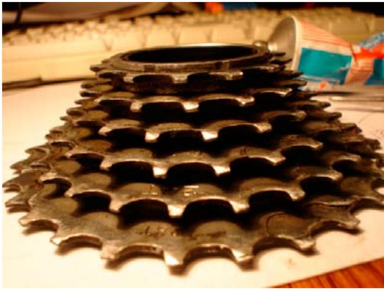
11. Ставим блок звездочек на втулку с приклеенными шариками и торчащими в разные стороны собачками процедура неприятная, собачки мешают просто одеть блок звездочек - поэтому придется поиграть им в горизонтальной плоскости, подвигать по оси проходящей через выступающие собачки, при этом умудрившись не отклеить шарики; проверить не отклеились ли можно после того как блок звездочек сядет, приподняв всю сборку за внутреннюю втулку - если под ней шариков нет, то все благополучно завершилось
