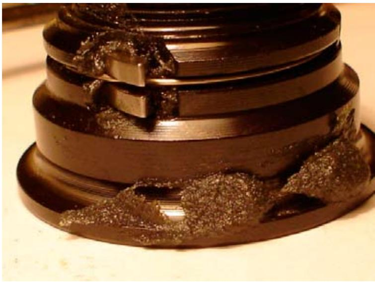
7. Наносим смазку на беговую дорожку подшипника для собачек, подшипников, да в принципе как и для всего другого, достаточно крупного и стального, я использовал ШРУС-4
