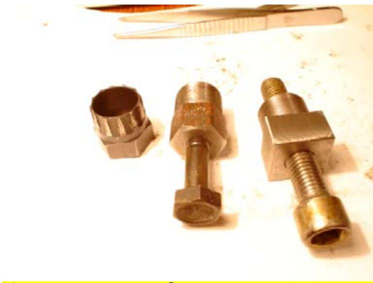
Мои съемники - справа 2 самодельных; слева - покупной, но и его пришлось поправить на электроточиле
