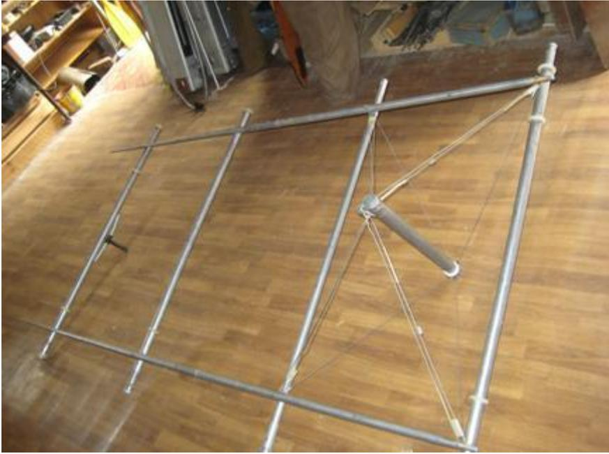
*На схеме и фото идея складной рамы: вороток или гайка-барашек в районе пятнера втугую натягивает все восемь тросиков одновременно и придает жесткость раме, после чего корпус не «луноходит»*
