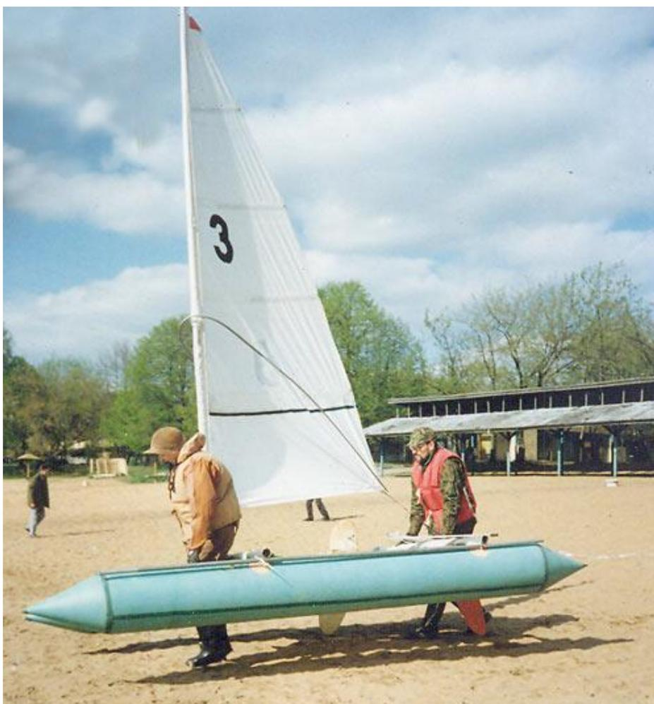
*«Три века» с экспериментальным парусом: нижняя часть соединяется с верхней с помощью «молнии»*
