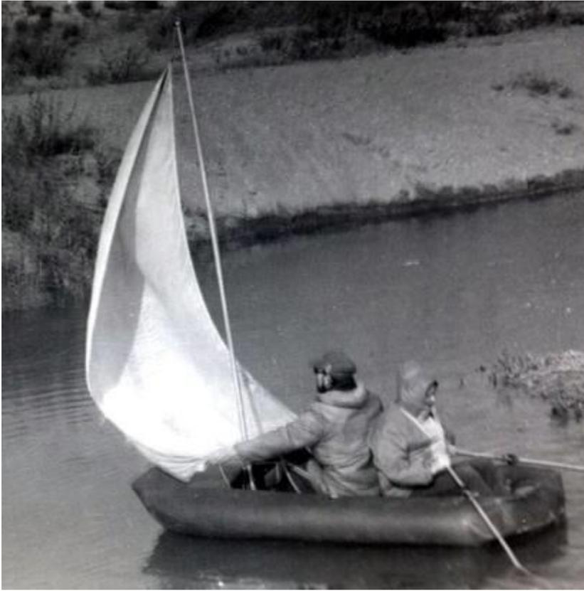
*Лодка «Ока» с экспериментальным парусом на Кайраккумском водохранилище*
