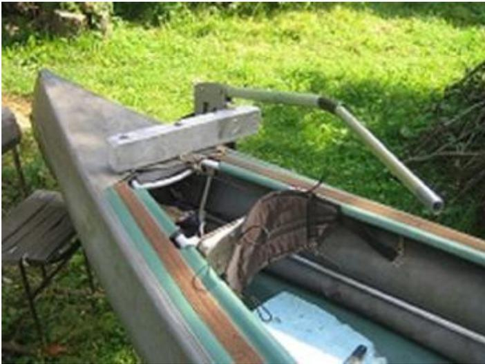
*Поперечная балка для руля и мотора. Под фальшбортами вторая балка, стянутая с верхней балкой двумя болтами*
